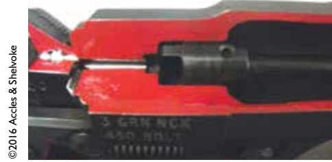
Fig. 8.05 A haste de limpeza no furo/pistão
