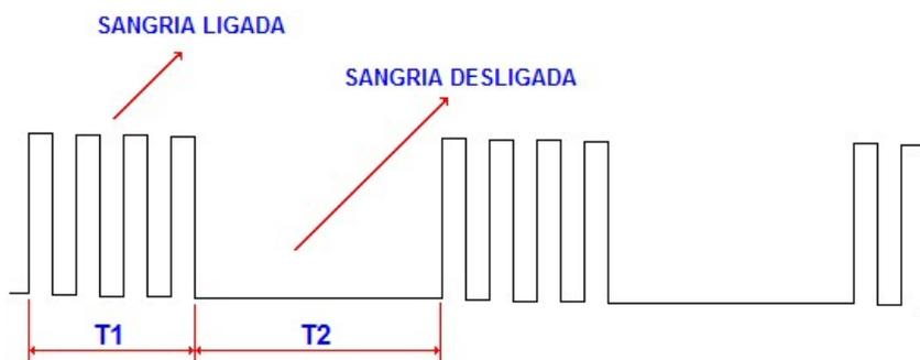
Figura 1 – Exemplo de Funcionamento da sangria com intervalo
