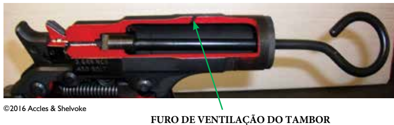
Fig. 8.04 Haste de limpeza em uso numa CASH Special
