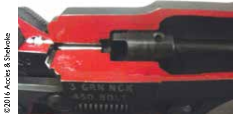
Fig. 8.05 A haste de limpeza no furo/pistão
